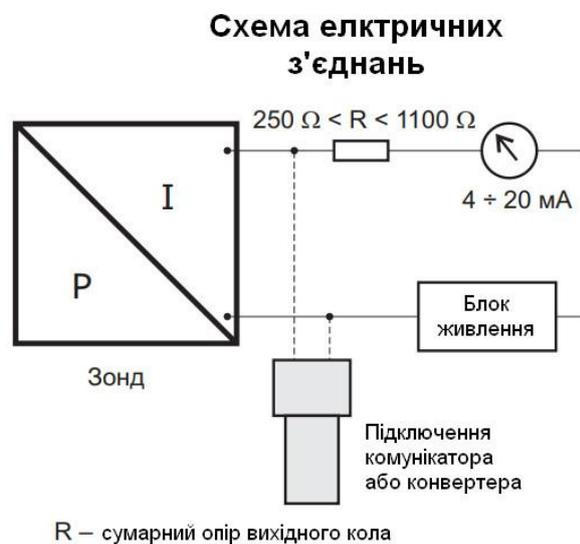
Малюнок 2 – Схема електрична підключення перетворювача
