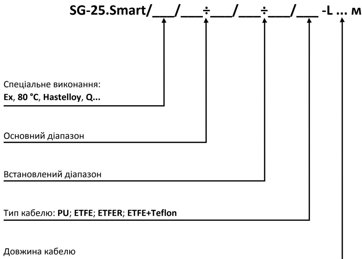
Приклад: Перетворювач тиску вимірювальний (гідростатичний зонд глибини) SG-25.Smart/
