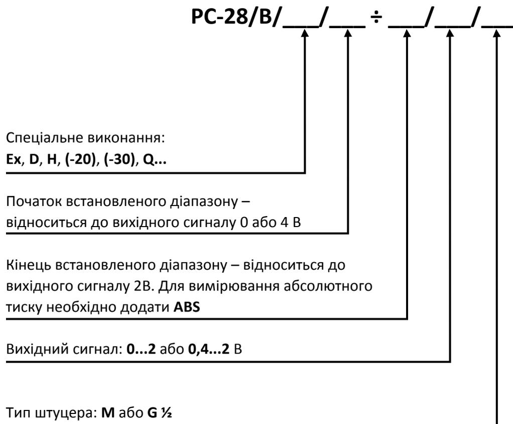
**Приклад:** Перетворювач тиску вимірювальний РС-28/В/0÷100 кПа ABS/ вихід перетворення (0...2) В// штуцер М20х1.5 з отвором Ø4.
