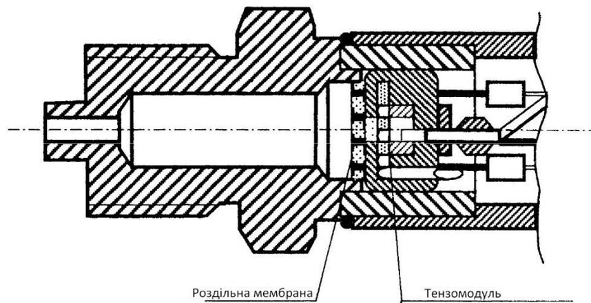
Малюнок 1 – Будова вимірювального модуля
