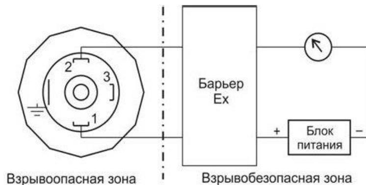
Малюнок 3 – Схема електричних підключень перетворювача в іскробезпечному виконанні
