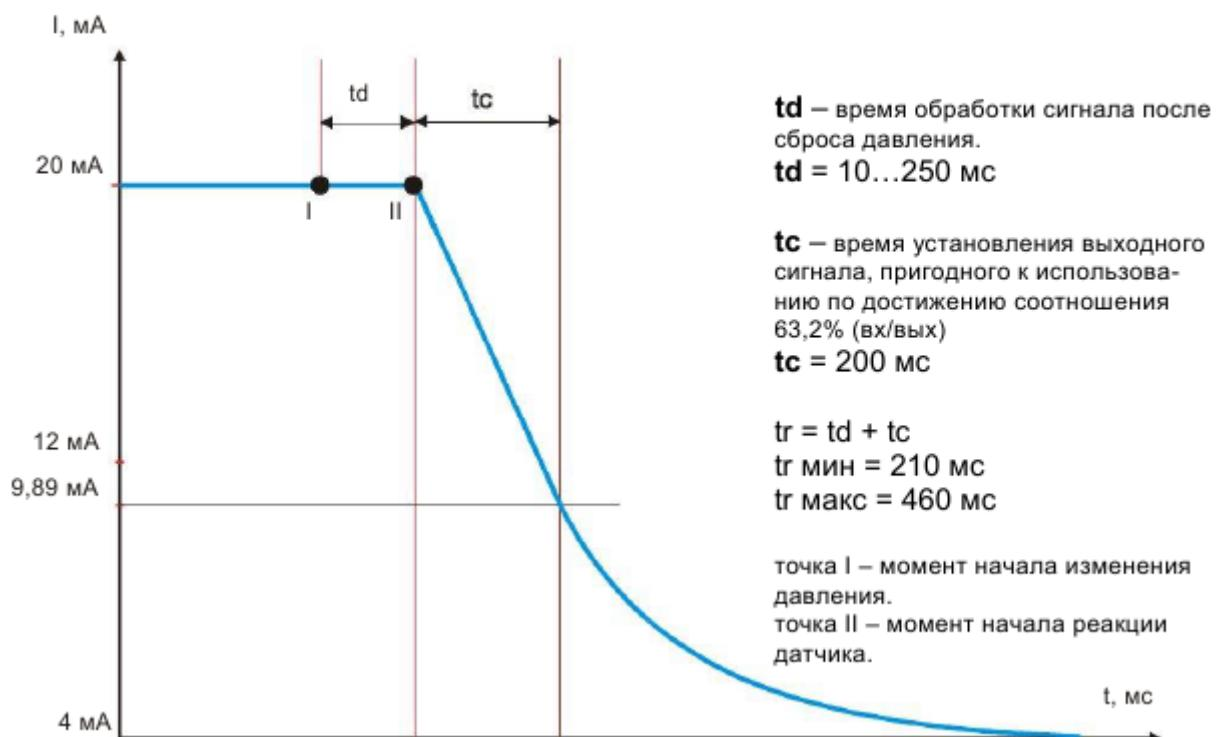
Перетворювач тиску ALW з виходом 4 - 20 мА, час реакцїї на зміну (кідок) тиску -  $tr$ , цикл вимірювання 0,5 сек. Час демпфірування (damping) = 0
