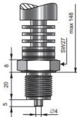
**Тип RM** Радіатор со штуцером М
