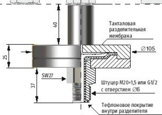
Исполнение с присоединением M20×1,5 или G1/2
