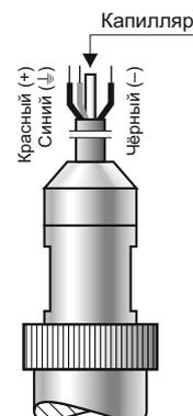
**Зонд PC-28P, электрическое присоединение типа РК**
