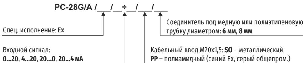
**Пример:** Преобразователь PC-28G/A, искробезопасное исполнение, вход 4...20 мА, металлический кабельный ввод, пневматическое подключение трубкой Ø8
