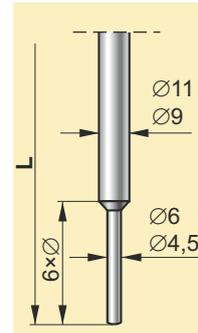
Специальное исполнение с редуцированным диаметром защитного корпуса в месте срабатывания чувствительного элемента. Применяется для ускорения динамической характеристики при сохранении механической прочности защитного корпуса в целом.
