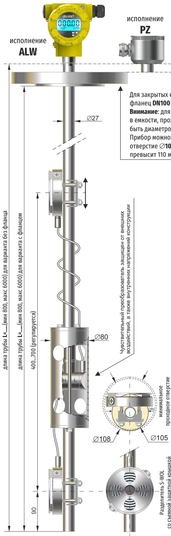
**Универсальный конструктивный вариант со стойкими разделителями S-WOL для более жестких условий** (напр. измерение плотности буровых растворов). **Предназначен для закрытых и открытых сосудов, имеющий возможность регулирования расстояния между разделителями.**
