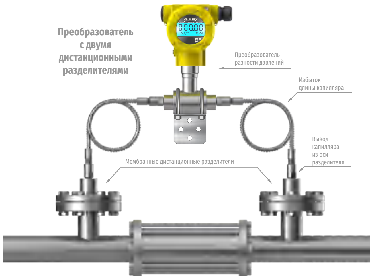
Пример измерения перепада давления на фильтре
