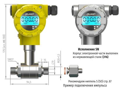
Преобразователь **APR-2000AL**Присоединение **P** со штуцерами. Допустимое статическое давление **4 МПа**
