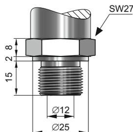
**Тип P** Штуцер M20×1,5, отверстие  $\varnothing 12$
