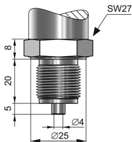
**Тип М** Штуцер M20×1,5, отверстие  $\varnothing 4$
