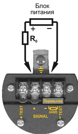
Коммуникатор или конвертер HART подключаем на **TEST+, SIGNAL+** (любая полярность)
