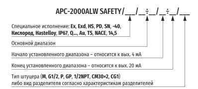
Пример: Преобразователь APC-2000ALW Safety / исполнение Ex / осн. диапазон 0 ÷ 700 кПа / установленный диапазон 0 ÷ 600 кПа / штуцер M20×1,5 с отверстием ∅4
