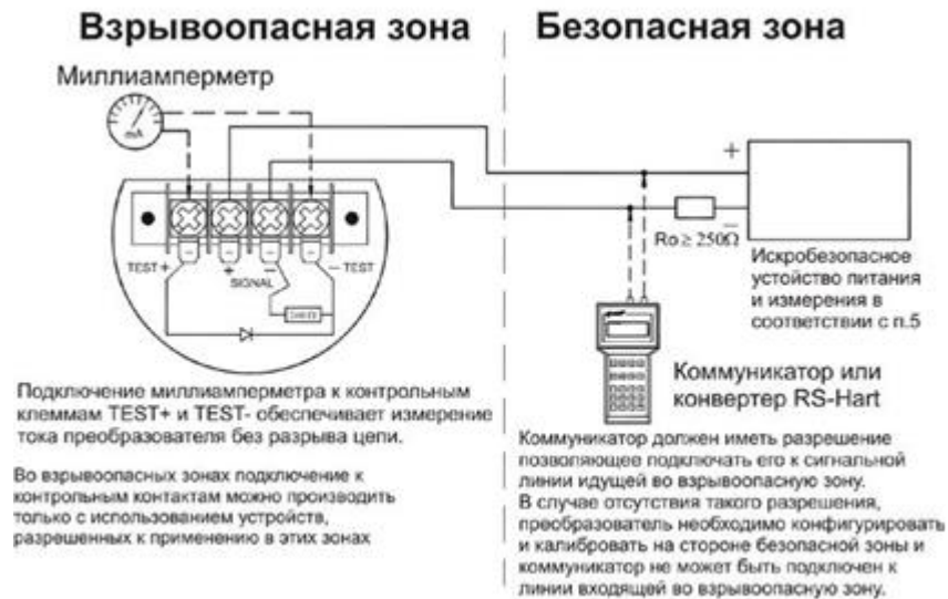
Малюнок 9 – Схема електричного підключення перетворювачів виконання Exd Ga/GbExia/dIICT6/T5X;
