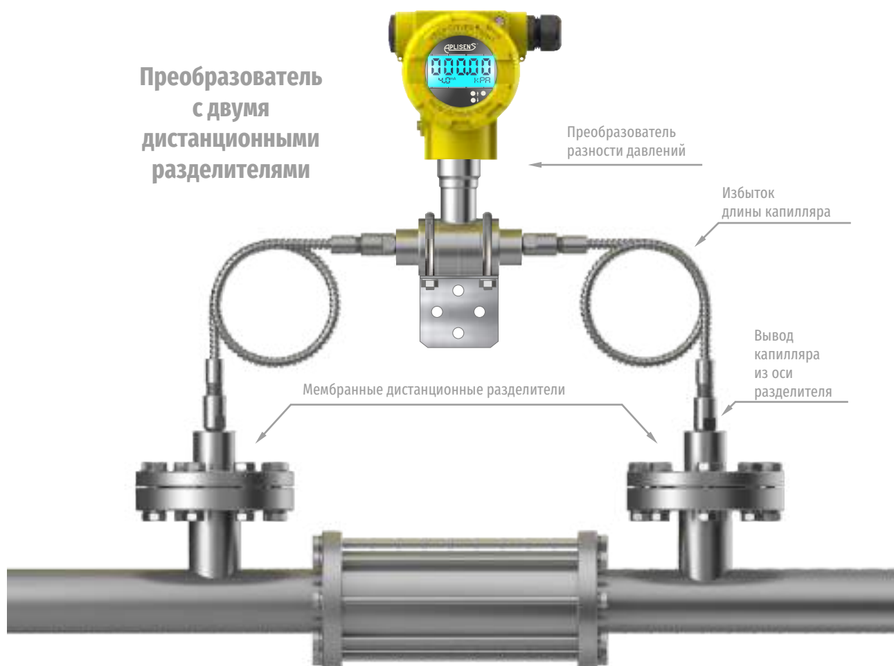
Пример измерения перепада давления на фильтре
