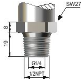
Тип 1/2NPT Штуцер 1/2NPT Диапазон макс 0...70 МПа Отверстие G1/4" Материал: 316L
