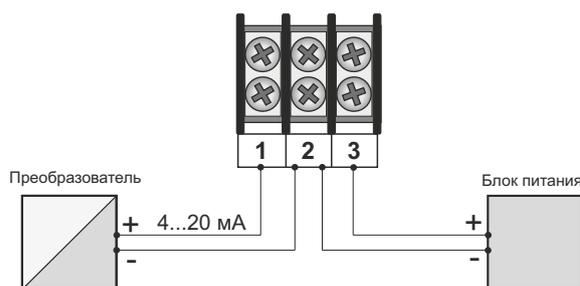
Схема электрических присоединений
